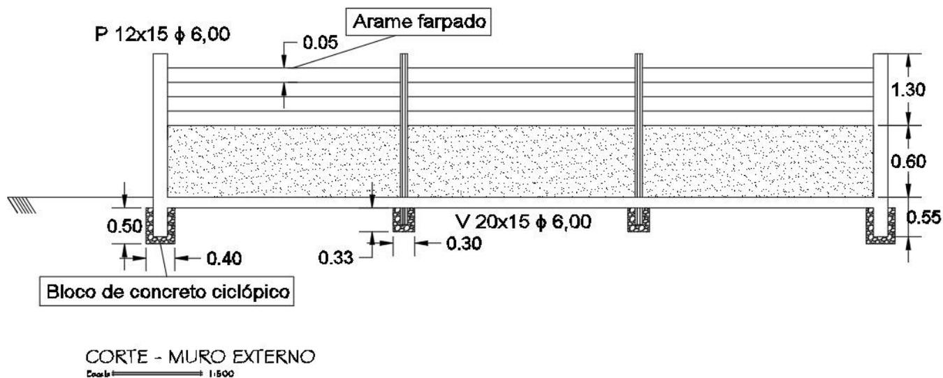
As fundações serão diretas, do tipo blocos de fundação conforme foto acima e segue detalhado no projeto estrutural anexo a este memorial descritivo.
